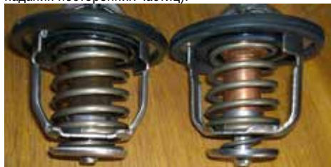
Заклинивание термостата в открытом положении.
