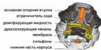
Когда растут обороты коленчатого вала, вместе с ними увеличивается амплитуда и скорость колебаний. Мембрана уже не может справиться с возросшей нагрузкой, и в работу вступают дресселирующие каналы. Под давлением жидкость через них перетекает из верхней камеры в нижнюю - жесткость и энергоемкость опоры увеличиваются.
