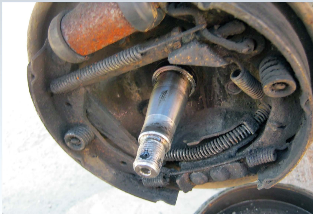
Прежде чем надевать на цапфу новый барабан, обратите внимание на состояние ее поверхности. Поскольку на ней сидят подшипники, следы износа не допускаются.
