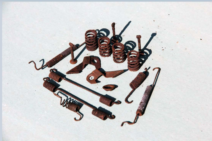
Коррозия безжалостна к пружинам тормозного механизма. Меняйте их, не жалея, на новые. Если колодки не будут двигаться должным образом, то износ фрикционных и, соответственно, барабанов будет идти более интенсивно, снижая ресурс деталей.
