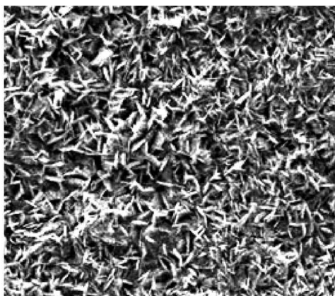
Рис. 4. Слой фосфата цинка. Диски — это кристаллы фосфата, которые защищают пружину и способствуют лучшему нанесению окраски
