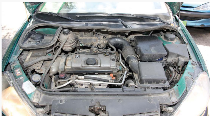
Компоновка подкапотного пространства достаточно плотная, что затрудняет проведение ряда ремонтных операций
