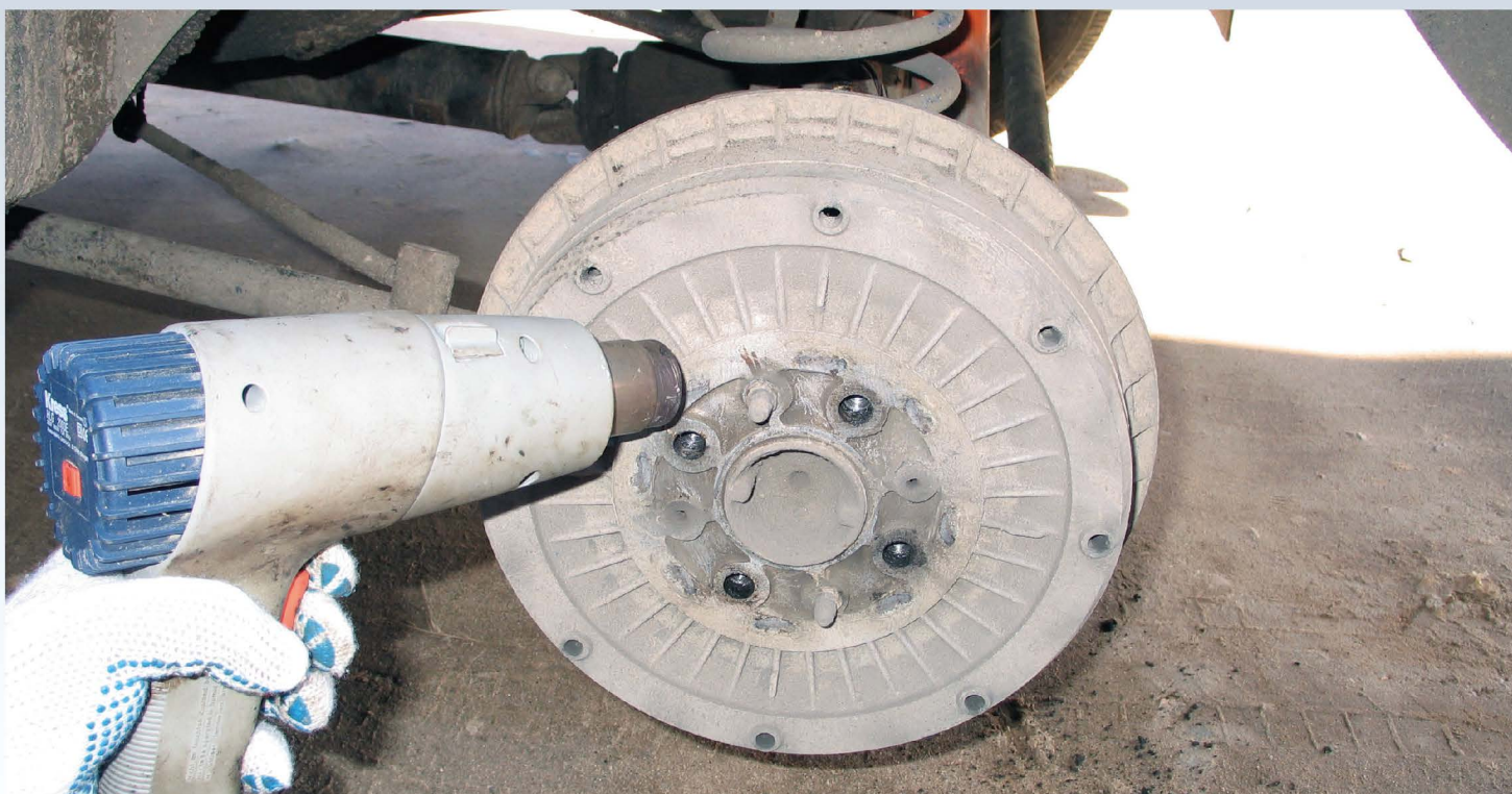
Если тормозной барабан намертво прикипел к ступице, то прежде чем его сбивать, рискуя повредить края, а то и вовсе оторвать кусок, попробуйте нагреть место посадки промышленным феном.
