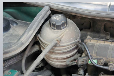
Перед покупкой автомобиля обязательно загляните внутрь расширительного бачка – нет ли там масляных пятен
