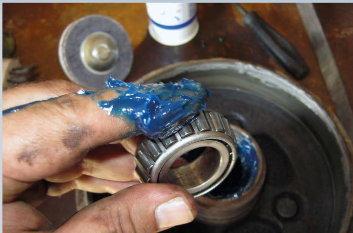
При каждой замене колодок тщательно промывайте подшипниковый узел тормозного барабана и закладывайте свежую смазку.
