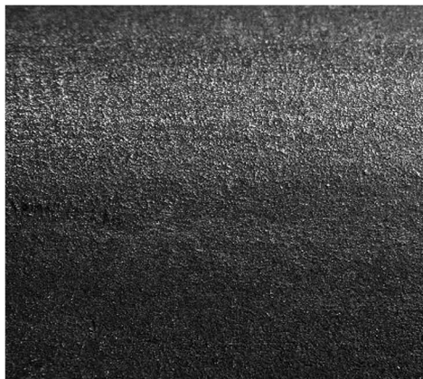
Рис. 2. Поверхность пружины перед дробеструйной обработкой
