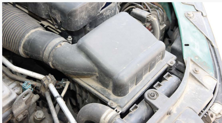
Корпус воздушного фильтра пластиковый. Сменный фильтрующий элемент панельного типа. При фиксации крышки винтами не стоит прилагать больших усилий – деформируете деталь
