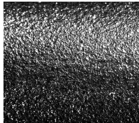
Рис. 3. Поверхность пружины после дробеструйной обработки
