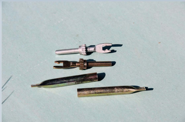
Новые распорные планки из одного комплекта с вилками, изготовленными из разных сплавов. Остается догадываться, какой из них подвержен коррозии и откажет быстрее.
