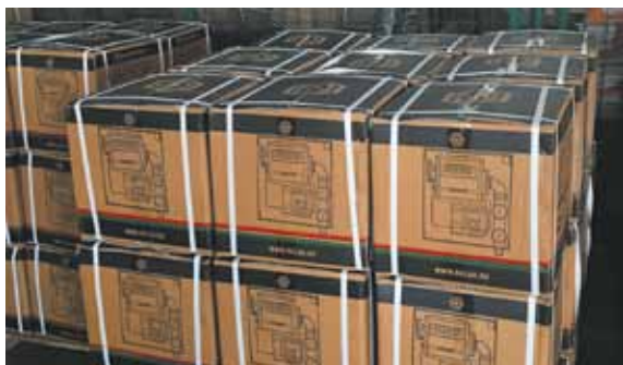
Насосы пакуются в фирменную упаковку из гофрокартона. Внутри каждая коробка имеет пенопластовый каркас, предохраняющий изделие от повреждений при транспортировке и хранении. На упаковку нанесена значимая информация об изделии и производителе.
