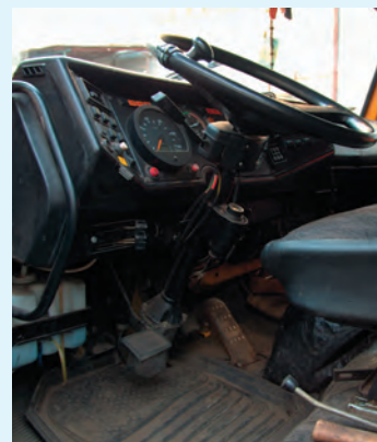
▲ Педальный блок выполнен ступенькой и требует от водителя привычки
