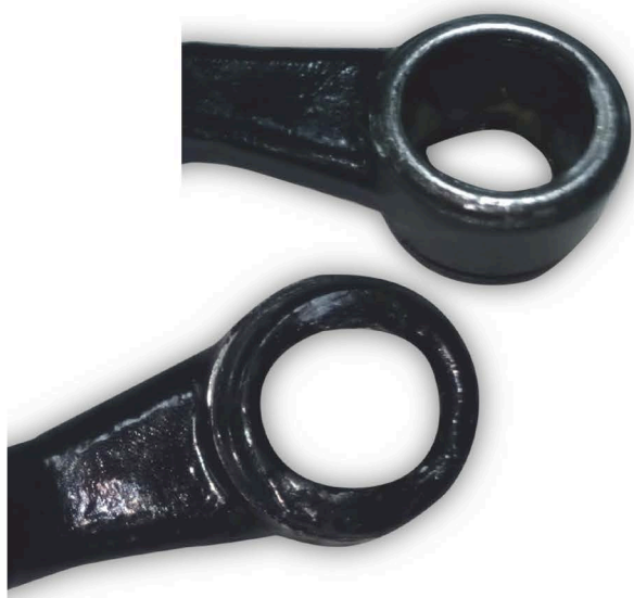
▲ Характер разрушений корпуса после испытаний на прочность заделки пальца
