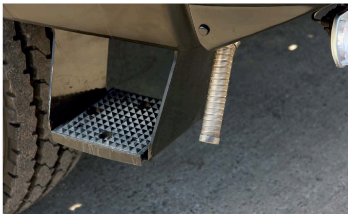
▲ На самосвалах, работающих в условиях бездорожья, нижняя ступенька в зоне риска, поэтому она должна иметь «мягкую» подвеску, то есть являться «складной». Благодаря мягким боковым элементам ступенька не гнется от контакта с препятствием
