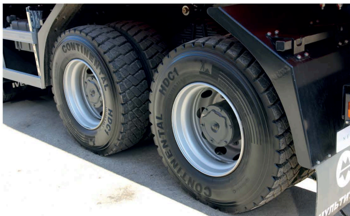
▲ Наилучший вариант ошиновки самосвалов — покрышками усиленной конструкции, имеющих «зубастый» протектор. Именно такая резина обеспечивает хорошую тягу на раскисшей грунтовке и стойко держит перегруз
