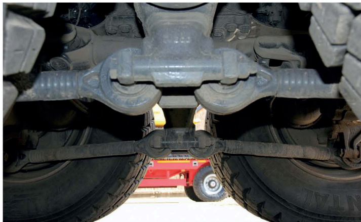
▲ В «ушах» реактивных тяг также запрессованы резинометаллические шарниры. Их размер подобран так, что сайлентблоки отлично работают даже в условиях воздействия на них нагрузок, близких к максимальным
