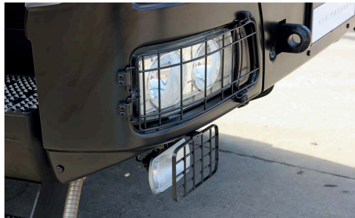
▲ Для грузовика, работающего в карьере или перевозящего грузы по грунтовкам, дорогам без твердого покрытия, защита фар сетками есть жизненная необходимость. Однако сетка не защищает покровные стекла от «пескоструя»
