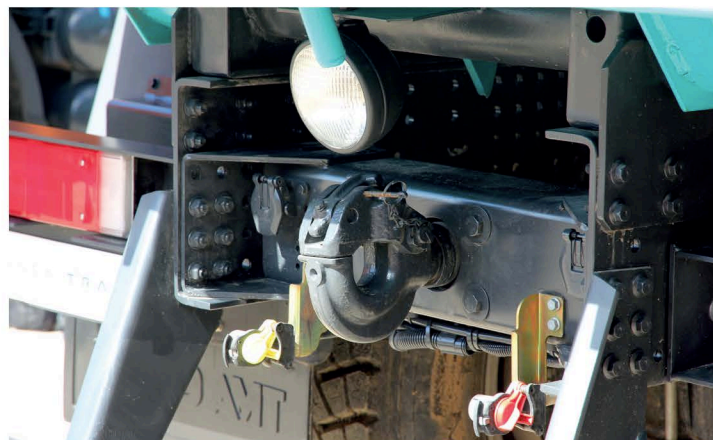
▲ Тягово-сцепное устройство поможет закрепить стальной трос и вызволить заставший на грунтовке грузовик или, используя самосвал в качестве тягача, подцепить к нему самосвальный же прицеп, улучшив эффективность перевозок
