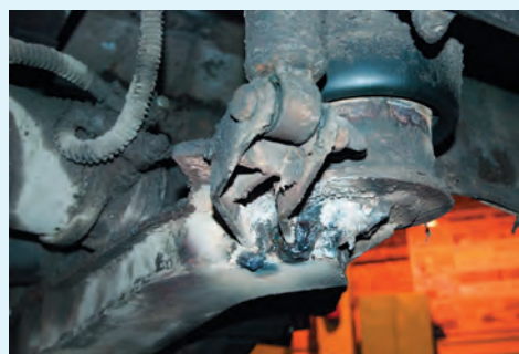
▲ Отламывающиеся чашки задних пневматических рессор слесарям 17-го автопарка приходится все время подваривать
