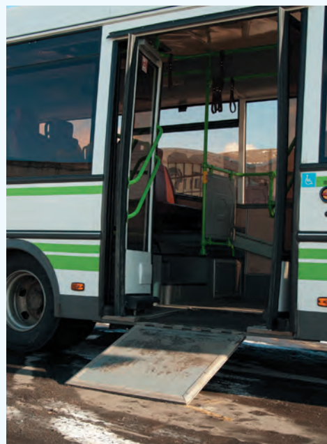
▲ Аппараты для инвалидов, имеющие простой и надежный механизм складывания, доказали свою необходимость у пассажиров
