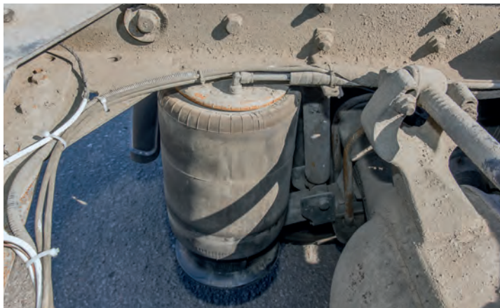
▲ Доступ к пневморессорам отличный. Их замена не вызывает никаких трудностей. Стоимость пневмобаллонов, в зависимости от бренда и их качества, колеблется от 7 до 19 тыс. рублей
