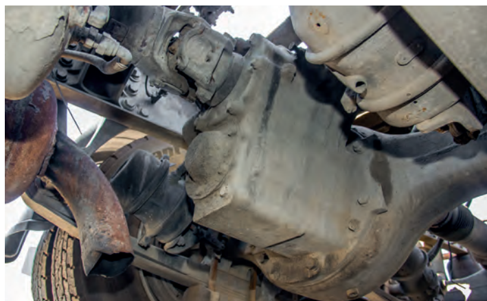
▲ На корпусах редукторов не должно быть следов потеклов масла. Перед приобретением машины уточните передаточное отношение редукторов – годятся ли они для выполнения транспортной задачи
