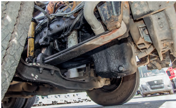
▲ Просевшие рессоры свидетельствуют о работе машины по плохим дорогам с перегрузом. Новая рессора стоит от 20 000 рублей
