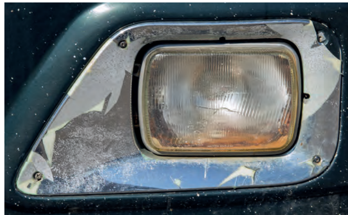
▲ У многих представленных на вторичном рынке машин фары с трещинами. Если отражатель потерял свои свойства, то освещение дороги будет неудовлетворительным. Оптику альтернативного производства можно приобрести примерно за 3,5-4,5 тыс. руб.
