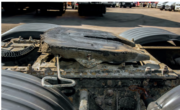
▲ Неужоженное, лишенное регулярной смазки седельно-сцепное устройство – признак того, что машиной владел «наездник». Как правило, другие узлы и агрегаты грузовика будут в неудовлетворительном состоянии
