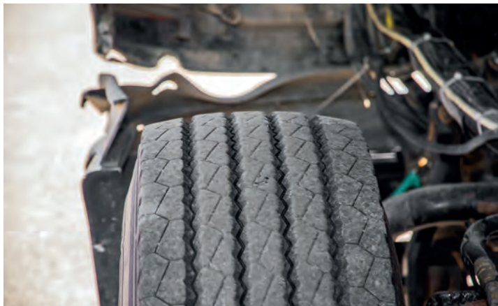
▲ По характеру износа шин рулевой оси можно судить об исправности ходовой части грузовика и элементов рулевого управления
