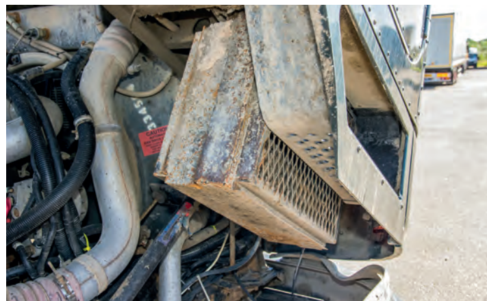
▲ Несмотря на продольное (относительно оси автомобиля) расположение радиатора кондиционера, его соты часто сильно забиты грязью
