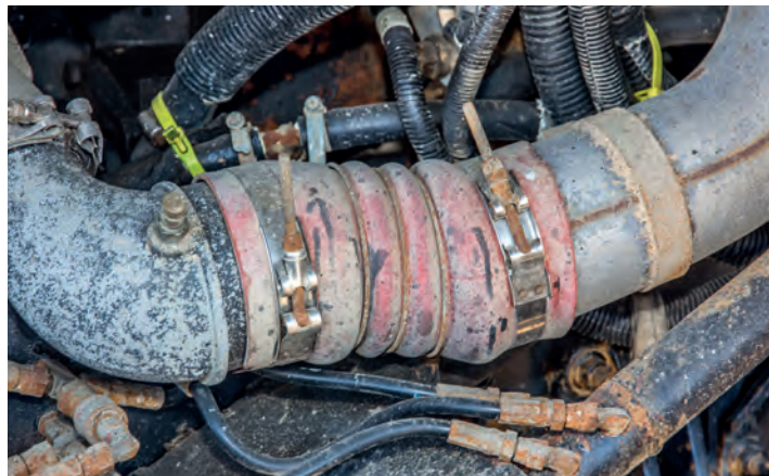
▲ Чтобы исключить проникновение неочищенного воздуха во впускной тракт, обязательно проверяем целостность гибких соединительных муфт
