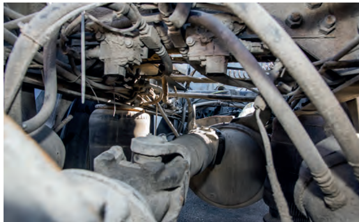
▲ Передний редуктор – проходной. Крутящий момент между ведущими мостами передается коротким валом
