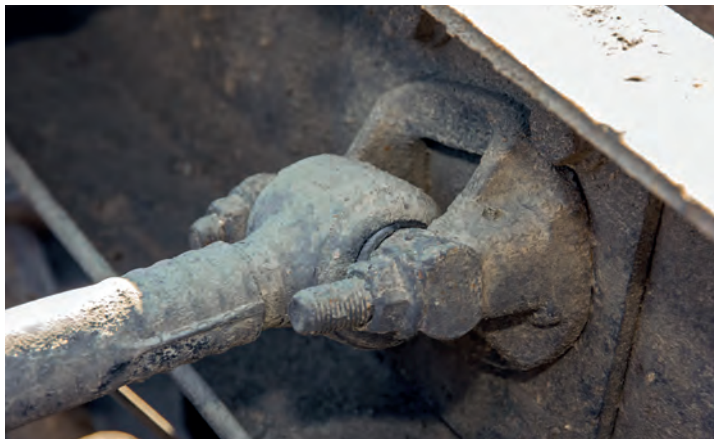
▲ Заменять изношенные сайлентблоки реактивных штанг часто просто невыгодно. Быстрее и эффективнее заменить тягу в сборе
