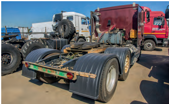
▲ Приобретая International 9800, обратите внимание на то, что машина может быть гидрофицирована. Это означает, что тягач работал, например, с самосвальным полуприцепом
