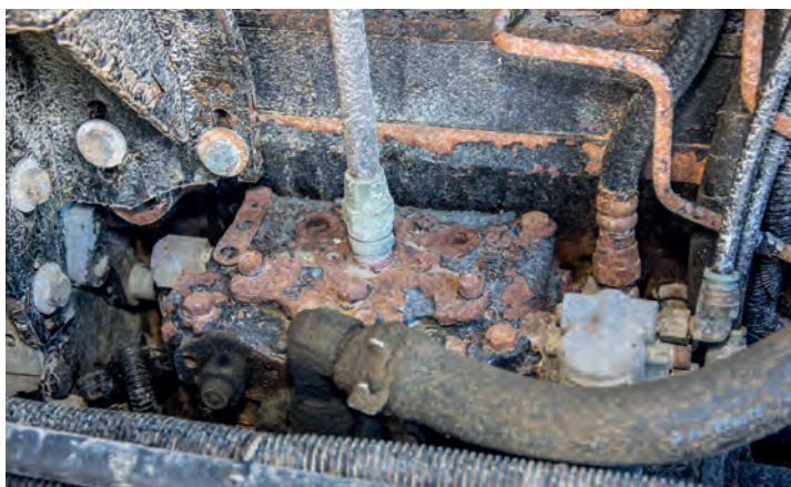
▲ От технического состояния пневмокомпрессора зависит работоспособность тормозной системы грузовика и прицепа. Если агрегат начал гнать масло в систему, его необходимо либо отремонтировать, либо заменить
