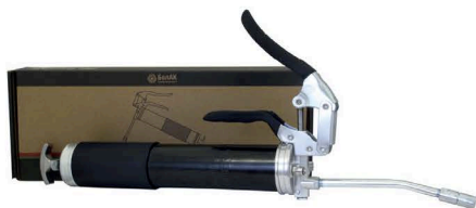
Шприц пистолетный. Артикул: БАК.90511 Материал: алюминий/сталь Объем: 500 мл Рабочее давление: 31 МПа Загрузка смазки: универсальная
