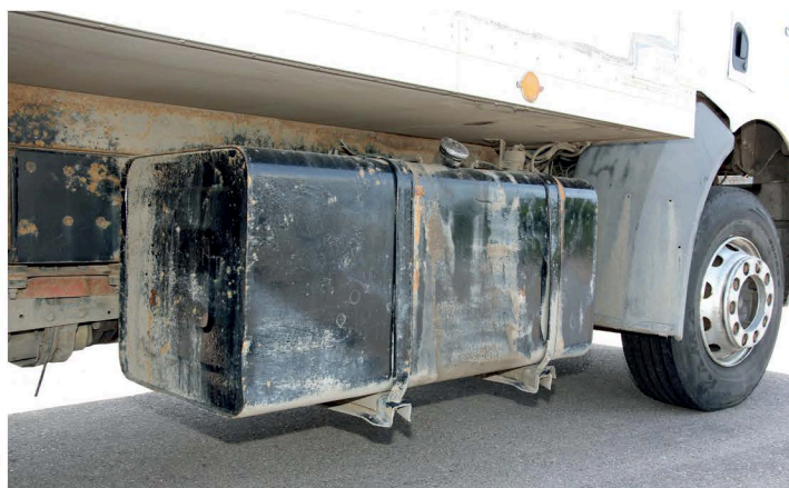
▲ Перед началом эксплуатации грузовика мастера независимых СТО настоятельно рекомендуют произвести тщательную промывку и пропарку топливного бака. Часто на его дне обнаруживаются слой осадка и вода
