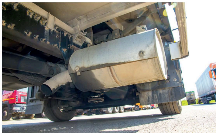
▲ Заварить прогоревший глушитель возьмется на любом СТО, а заменить его стоит не более 5000 рублей. Для справки: обеспечение требований по чистоте выхлопа на уровне Евро-4 достигнуто применением системы EGR, а также установкой сажевого фильтра
