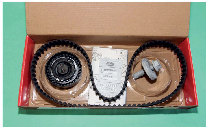
▲ Комплект привода газораспределительного механизма должен включать в себя все заменяемые компоненты, в том числе крепеж, который нельзя использовать повторно
