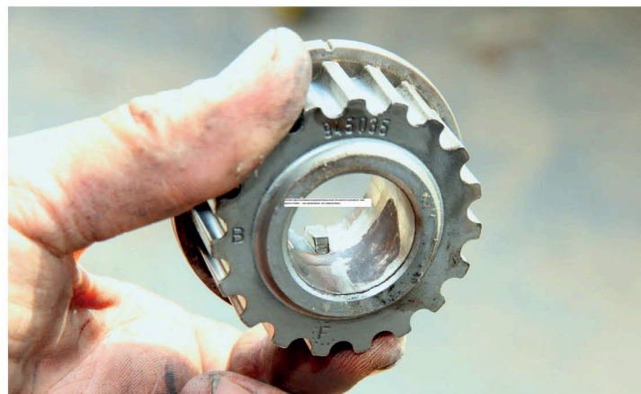
▲ Окислы, присутствующие на внутренней поверхности шестерен, аккуратно убираем мелкозернистой «шкуркой». При установке шестерни на вал наносим на поверхности консистентную смазку. Она не даст развиваться коррозионным процессам и облегчит демонтаж шестерни при очередной замене ремня
