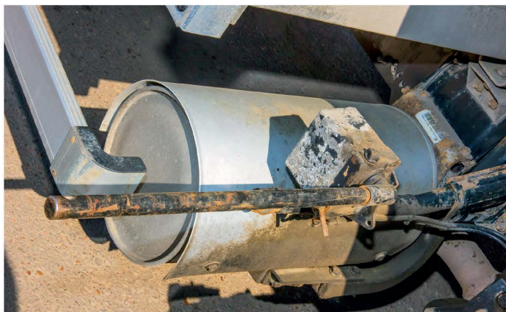
▲ Гидравлический механизм подъема кабины с ручным приводом. Именно такая простая, надежная конструкция и нужна для российских условий эксплуатации
