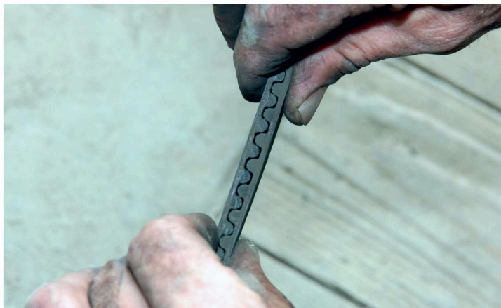
▲ Иногда мастера производят косвенную (визуальную) оценку степени износа ремня по зазорам между зубьями, складывая две ветви. Данный метод не является объективным
