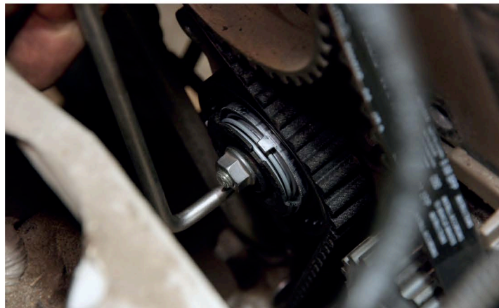
▲ Большинство натяжных роликов имеет простой и понятный механизм регулировки, что облегчает задание требуемого усилия. В данном случае всё, что нужно сделать мастеру, это совместить пропил с выступом, вращая механизм посредством специального ключа
