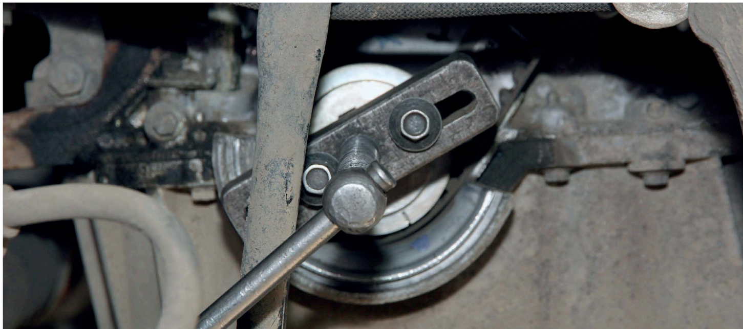
▲ Рабочему ходу приспособления могут мешать различные конструктивные элементы. Их придется демонтировать
