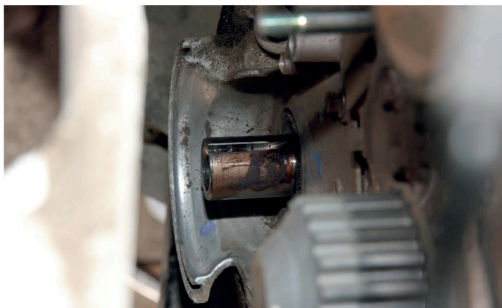
▲ Причиной «прикипания» шестерни к носку коленчатого вала в большинстве случаев является коррозия. Ее образование довольно часто фиксируется даже на относительно свежих машинах
