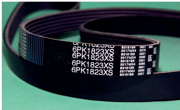
▲ Ремни от альтернативных производителей должны точно соответствовать по своим параметрам оригиналу. Все данные содержатся в маркировке. Будьте внимательны при покупке!
