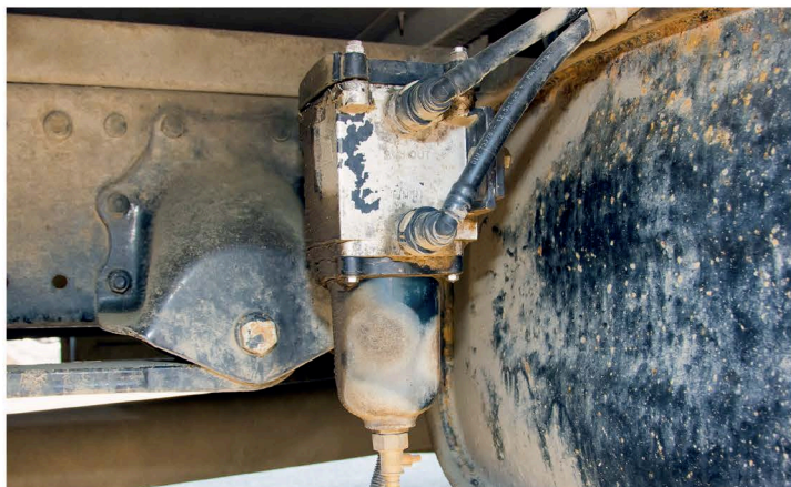
▲ Лучший фильтр-сепаратор должен быть с подогревом и системой автоматического сброса отстоя. Это позволит избежать повреждения топливной аппаратуры при заправке топливом с большим содержанием воды
