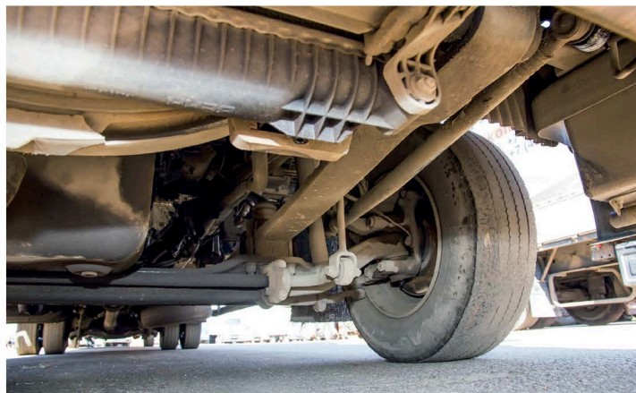
▲ Передние рессоры – «лыжи» – обеспечивают комфортные условия в кабине, однако вечными не являются. Покупать на замену оригинал ценой под 40 000 рублей очень накладно, тем более когда есть достойная альтернатива от Weweler ценой 25 000 рублей
