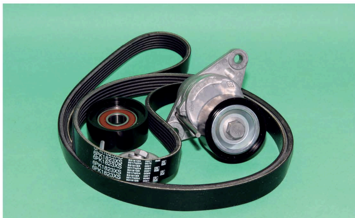
▲ Комплект привода вспомогательных агрегатов, упакованный в коробку с логотипом того или иного бренда, может содержать ремень и ролики разных производителей
