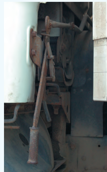
▲ механический привод подъёма кабины
