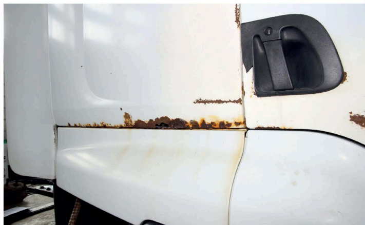
▲ На старых машинах можно встретить коррозионные разрушения некоторых панелей кабины. Если вас не волнует эстетическая сторона вопроса, то оплачивать услуги мастеров кузовного участка нет смысла. Эти деньги можно потратить с большей пользой
