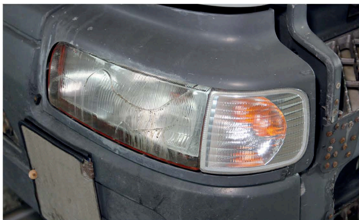
▲ Грузовики с пробегом под миллион километров часто имеют оптику, замутненную пескоструем или, того хуже, с трещинами покровного стекла. Фару от альтернативного производителя можно приобрести всего за 6000 рублей
