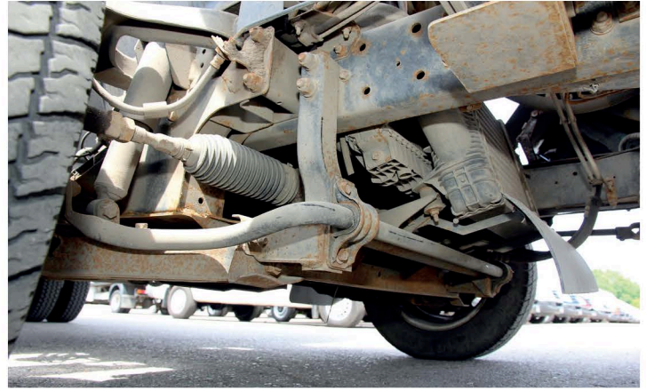
▲ При каждом ТО проверяем состояние резиновых чехлов рейки рулевого механизма
