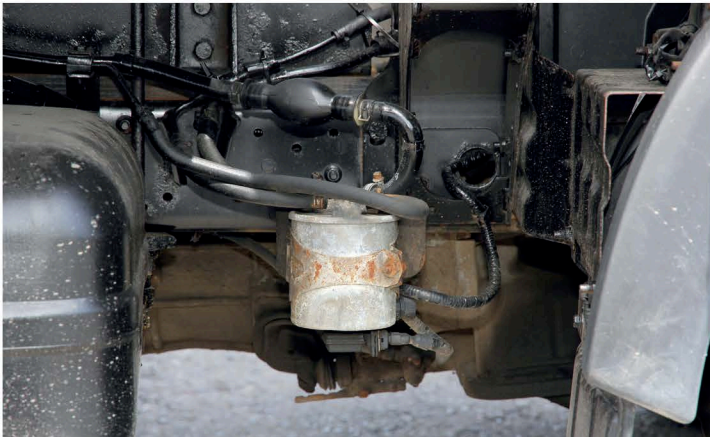
▲ Регулярная замена топливного фильтра – залог безотказной работы системы питания. Резиновая груша поможет заполнить топливом магистраль при замене фильтра
