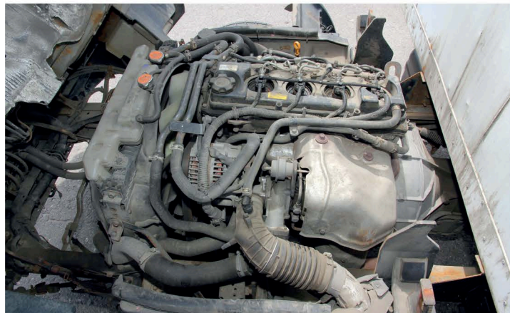
▲ Дизели обладают завидной надежностью и ресурсом более 500 000 км. Главное регулярно обслуживать мотор с применением качественных масел и фильтров
