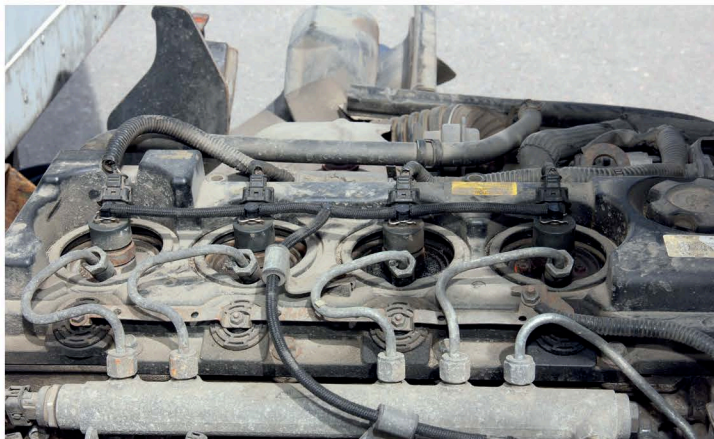
▲ Система питания Common Rail весьма требовательна к качеству топлива и дорога в ремонте
