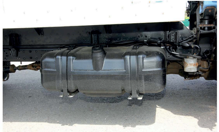
▲ Если топливный фильтр засорится раньше положенного срока – промойте топливный бак. На его дне со временем скапливаются отложения грязи
