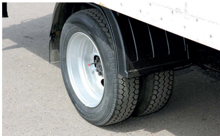
▲ Двухкатная ошиновка ведущего моста лучше однокатной при работе машины с перегрузом
