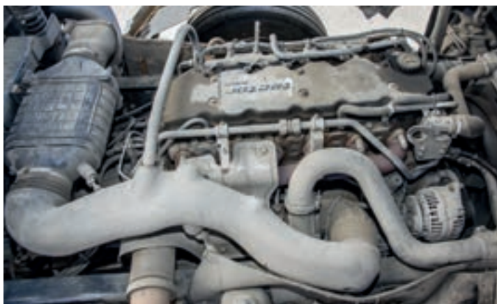
▲ В зависимости от модификации грузовики IVECO EuroCargo могут оснащаться либо четырьмя либо шестицилиндровыми двигателями. При надлежащем обслуживании, применении качественных фильтров и масел ресурс силовых агрегатов переваливает за миллион километров.
