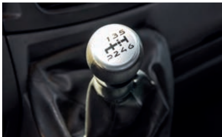
▲ Для развозного грузовика наличие шести ступеней в коробке передач более чем достаточно для обеспечения оптимальной нагрузки на двигатель и трансмиссию. Для работы на длинном плече, в составе автопоезда, грузовику нужна КПП с большим диапазоном передаточных чисел
