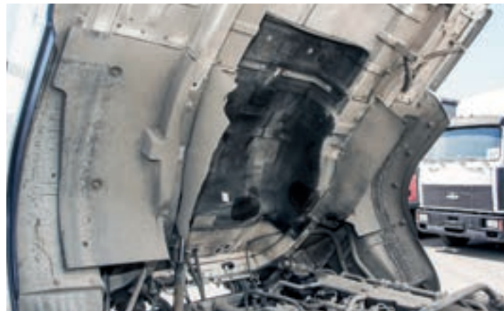
▲ На днище кабины ржавых пятен нет даже у машин с приличным пробегом, что говорит о качественной заводской обработке металла с применением современных материалов. Пескоструй от колес приходится точно в подкрылки, которые закреплены на дне кабины. Шумоизоляционный мат со своими обязанностями справляется. В кабине грузовика относительно тихо.
