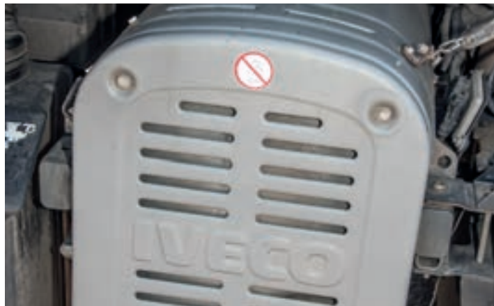
▲ На машинах с большим пробегом может потребоваться замена блока глушителя
