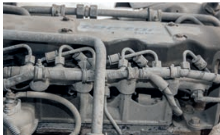
▲ Электронно-управляемая система питания Common-Rail очень требовательна к качеству топлива, а ее ремонт весьма дорог, так как переборка агрегатов предусматривает замену большого количества элементов. Кроме того, грамотно произвести ремонт тех же форсунок могут не многие специализированные компании, которые владеют необходимыми стендами и иным ремонтно-диагностическим оборудованием.
