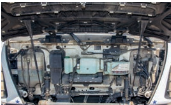
▲ Под облицовкой находятся бачки с техническими жидкостями. При проведении очередного технического обслуживания необходимо как минимум убедиться в том, что в антифризе нет сгустков, которые говорят, в частности, о срабатывании охлаждающей жидкости, а на его поверхности отсутствуют пятна масла и топлива
