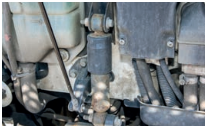
▲ Амортизаторы подвески кабины могут не иметь следов потеков масла, однако при этом их эффективность будет снижена до неприемлемого уровня. Если пробег грузовика больше полумиллиона километров, имеет смысл заложить в расходы покупку новых амортизаторов
