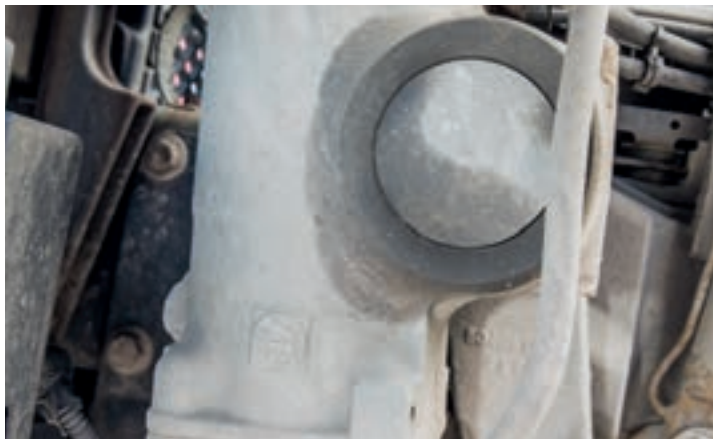
▲ Рулевой редуктор производства компании ZF редко требует к себе внимания со стороны ремонтников. Легкое опотевание маслом не является признаком неисправности агрегата. При должном уходе рулевые машинки ходят вплоть до списания грузовика.
