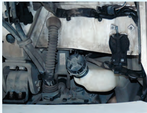
▲ Крышка передней панели кабины обеспечивает доступ к техническим узлам и заправочным емкостям
