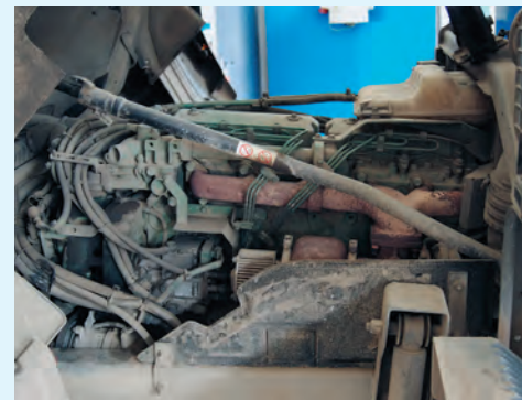
▲ Откинутая кабина обеспечивает хороший доступ к обслуживанию шестицилиндрового силового агрегата Volvo FL
