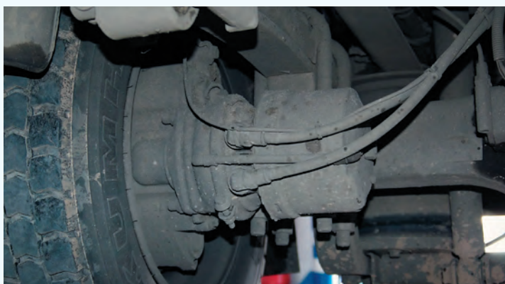
▲ Узел тормозной системы и подвески заднего правого колеса
