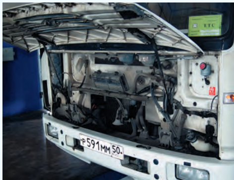
▲ Крышка передней панели кабины обеспечивает доступ к техническим узлам и заправочным емкостям
