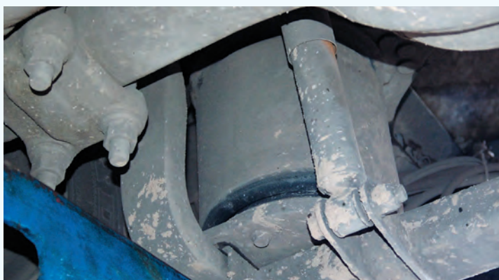
▲ На задней оси установлены пневморессоры
