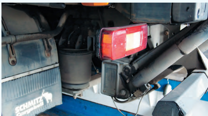
▲ тыльная сторона корпуса бортовых задних огней автомобиля надёжно изолирует лампы и плафоны от попадания внутрь грязи
