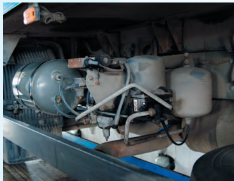
▲ Компрессор – сердце пневматической системы грузовика, расположен вполне удобно для обслуживания
