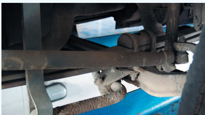
▲ Передняя подвеска крепится на двухлистных рессорах, колёса имеют простое и надёжное рулевое управление
