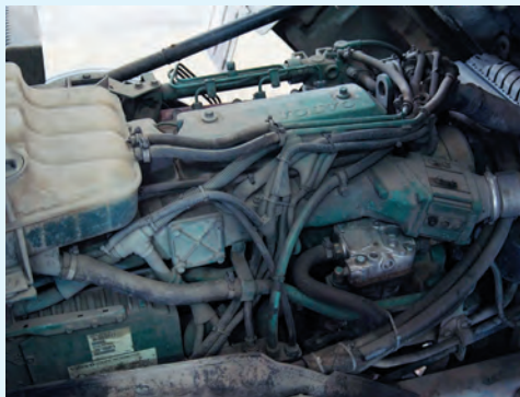
▲ Откидывающаяся кабина открывает доступ к двигателю
