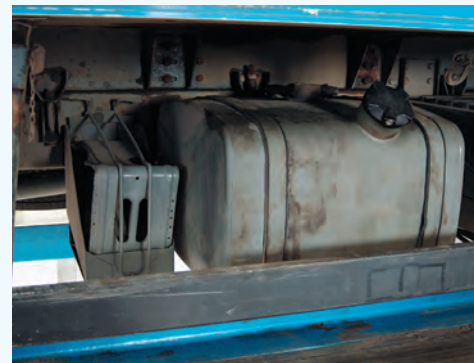
▲ Рядом с топливным баком закреплен противооткатный башмак
