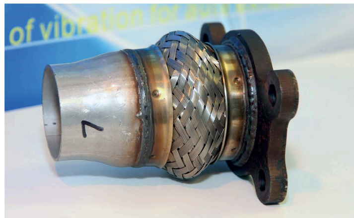
▲ Некоторые производители выпускных систем выделяют муфту в отдельный элемент. Тем самым существенно упрощают работы по ее замене
