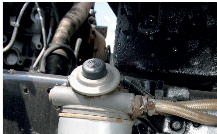
▲ Для защиты топливной системы от воды в топливе используется фильтр – сепаратор. Следить за уровнем конденсата в колбе и сливать отстой нужно регулярно
