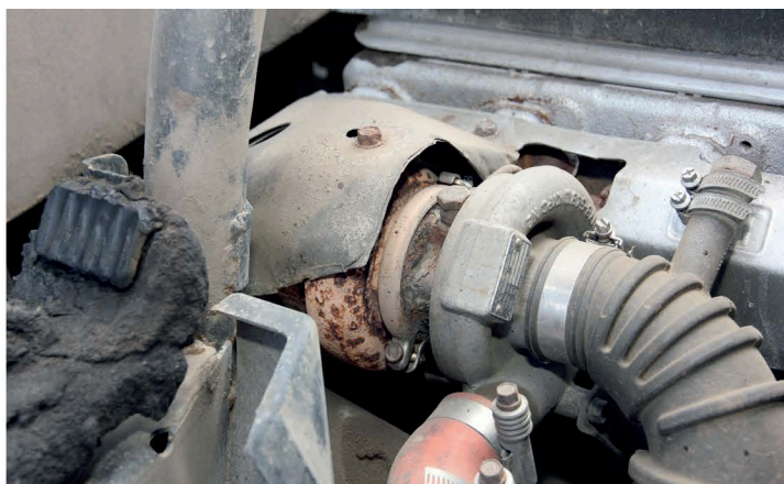
▲ При своевременной замене и использовании моторного масла соответствующего уровня качества турбокомпрессоры не требуют к себе внимания
