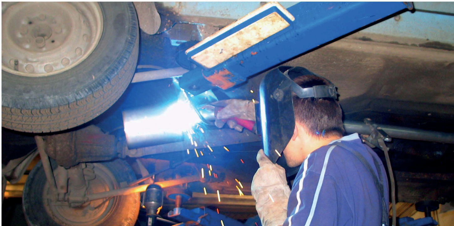
▲ При ремонте или сборке новой выпускной системы из универсальных компонентов детали часто соединяют сваркой прямо на автомобиле с подгонкой по месту
