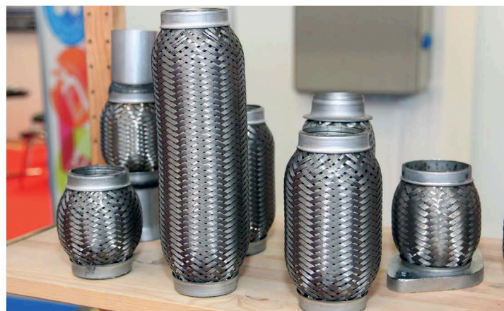
▲ Элементы, компенсирующие перемещение частей выпускного тракта, часто первыми выходят из строя. В мастерских их меняют прямо на машине
