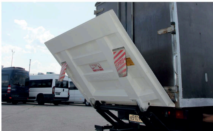
▲ Грузовики, оснащенные гидробортом, существенно упрощают перевозку различных крупногабаритных тяжелых грузов, например бытовой техники
