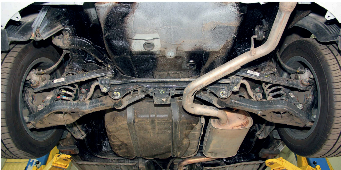
▲ Конечная часть глушителя с декоративной насадкой (на фото автомобиля Kia Seed) может быть довольно длинной и иметь сложную форму. Глушитель в этом случае расположен у бака в базе машины
