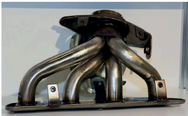
▲ Для оптимизации газодинамики конструкторы разрабатывают коллекторы со сложной геометрией. Их производство недёшево
