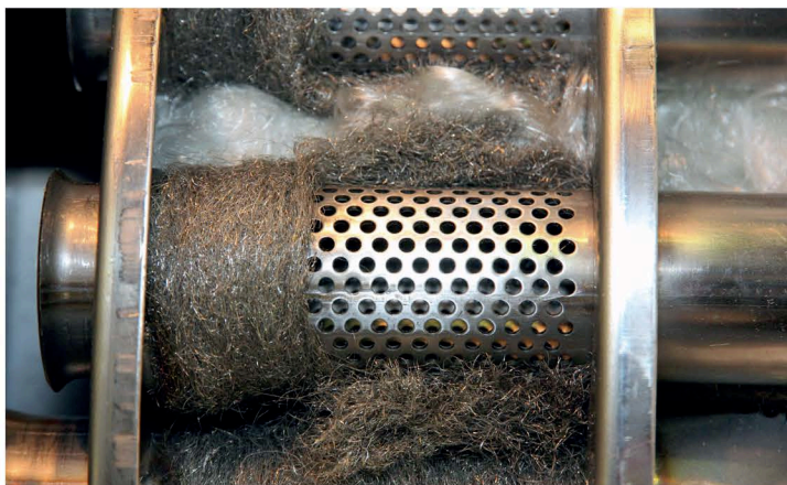
▲ От качества используемого наполнителя зависят рабочие характеристики и ресурс глушителя
