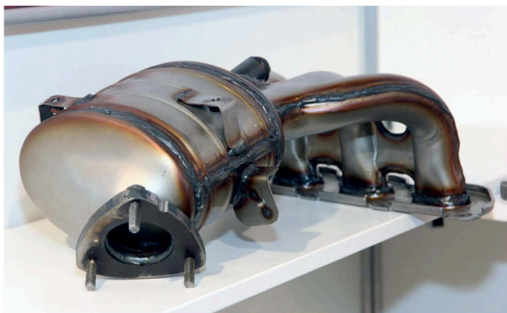
▲ Чтобы ускорить процесс прогрева каталитического нейтрализатора отработавших газов, его размещают поближе к выпускному коллектору
