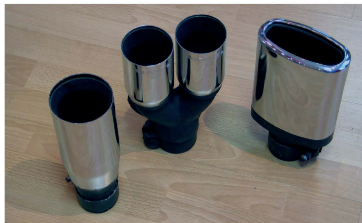
▲ Для того чтобы лаконично вписать оконечник глушителя в обвес или специальную нишу бампера, на него можно смонтировать насадку. Форм данных элементов великое множество. Подобрать подходящую по дизайну не проблема
