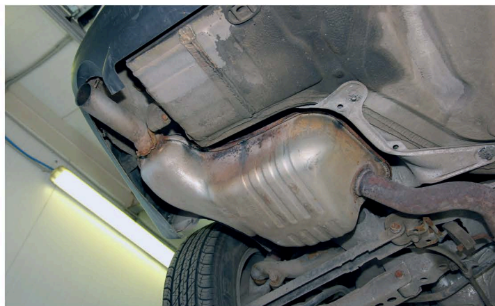
▲ Основной глушитель (на фото автомобиля Volvo S60) часто имеет достаточно сложную геометрическую форму. Приобретая аналог, важно убедиться, что он встанет в нишу, а кронштейны крепления совпадут с точками штатной подвески
