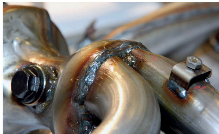
▲ Большое значение для надежности работы системы выпуска имеет качество сварочных швов. Автоматизировать процесс сварки удастся не всегда
