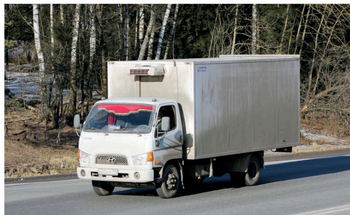
▲ Грузовик с изотермическим фургоном, оснащенный климатической установкой, – лучший вариант развозного автомобиля, обслуживающего продуктовые магазины
