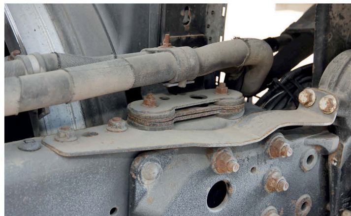
▲ Крепление радиатора системы охлаждения грузовика Volvo FL. Узлы должны не только обеспечивать прочное крепление, но и эффективно выполнять функции гасителей вибрации. А вибрационная нагрузка, идущая от дороги, очень велика
