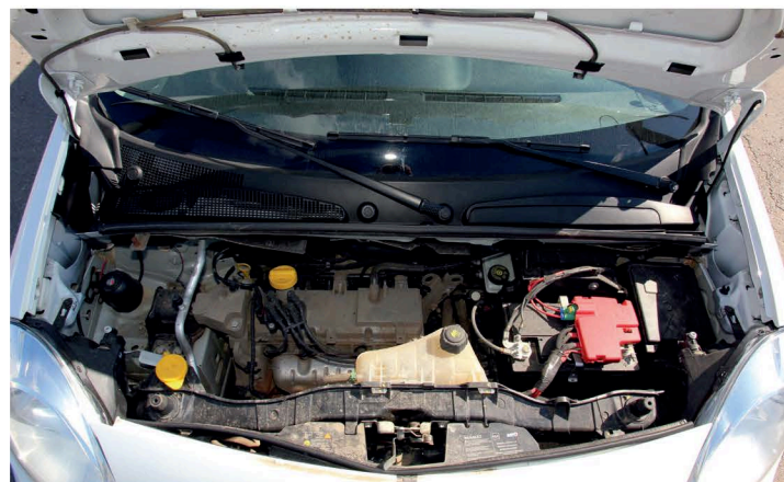
▲ Компоновка моторного отсека не такая плотная, как у одноклассников. Агрегаты находятся в относительно хорошем доступе. Операции по регламентному обслуживанию и ремонту проводить относительно незатруднительно
