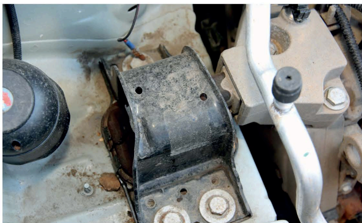
▲ Обязательно оцените состояние опор силового агрегата. У машин с пробегом более 100 000 км они могут «прослабнуть». Проще всего проверить их состояние по величине вибраций, идущих от мотора
