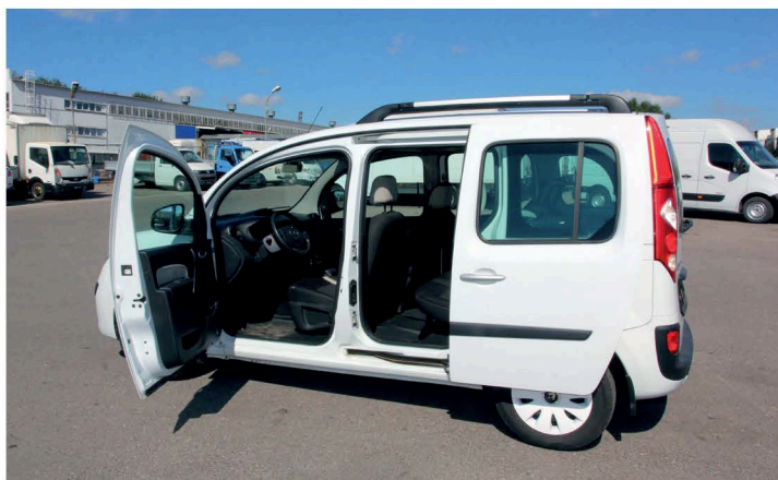
▲ Дверь второго ряда сидений сдвижная. За механизм следует следить, регулярно его смазывать. Особенно важно производить профилактические работы перед зимним периодом эксплуатации и по его окончании
