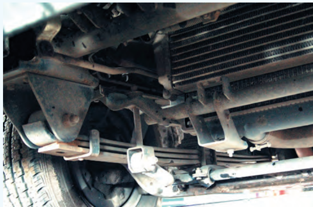
▲ Передняя подвеска Mitsubishi Canter на продольных рессорах славится своей «неубиваемостью» на российских дорогах
