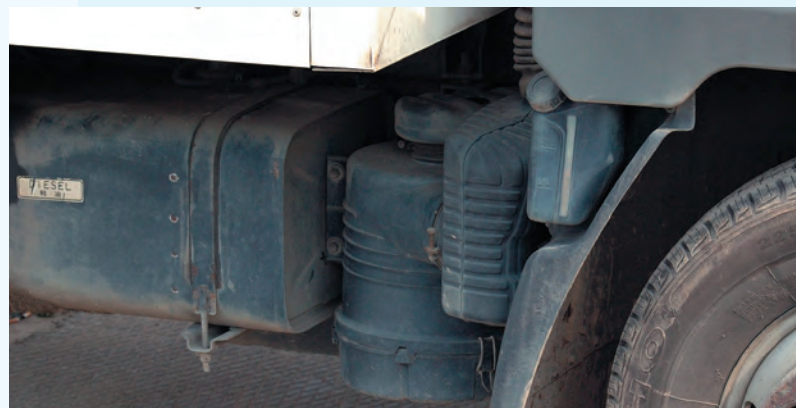
▲ ...Рядом с баком расположены отстойник воздушного фильтра, бачок для охлаждающей жидкости
