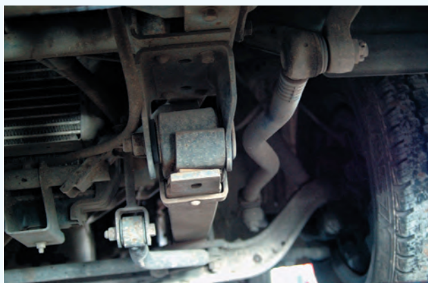
▲ Передняя подвеска Mitsubishi Canter на продольных рессорах славится своей «неубиваемостью» на российских дорогах
