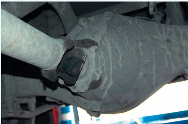
Крестовина карданного вала нуждается в периодической смазке
