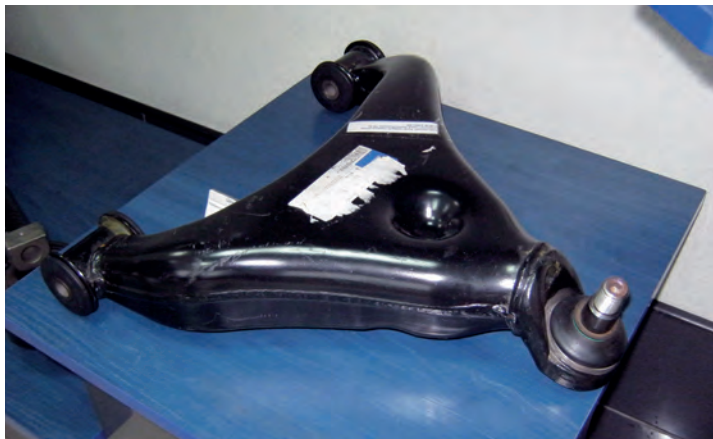
▲ В подвеске легкого коммерческого транспорта, например цельнометаллических фургонов, также применяются рычаги, что улучшает ходовые качества машин
