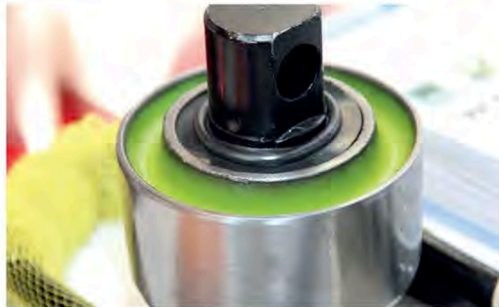
▲ Некоторые производители для повышения надежности элементов подвески изготавливают сайлентблоки с применением полиуретана особого сорта, что приводит к росту стоимости деталей
