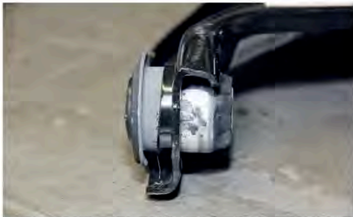
▲ Классический пример запрессовки резинометаллического шарнира в рычаг не до упора, а до строго определенного положения относительно отверстия. Выполнить его с высокой точностью в условиях мастерских без применения специальной оснастки – довольно хлопотное дело
