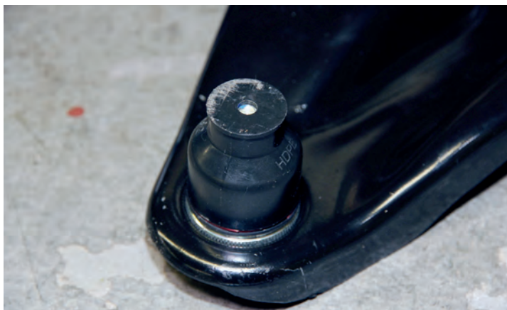
▲ Для предотвращения повреждения чехлов шаровых опор во время их транспортировки на них надевают специальные колпачки. Не все производители запасных частей из эконом-сегмента готовы тратить на эти важные мелочи
