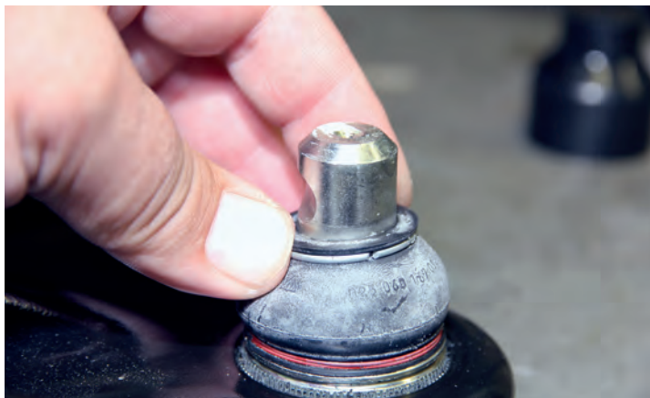
▲ Для фиксации пальца шаровой опоры в поворотном кулаке на его стержне может выполняться кольцевая канавка либо выбирается отдельный сегмент. При этом со сменой поколения машины может изменяться диаметр болта, который стопорит палец, при этом сам рычаг будет полностью идентичным. Обязательно обратите на это внимание для обеспечения возможности установки рычага
