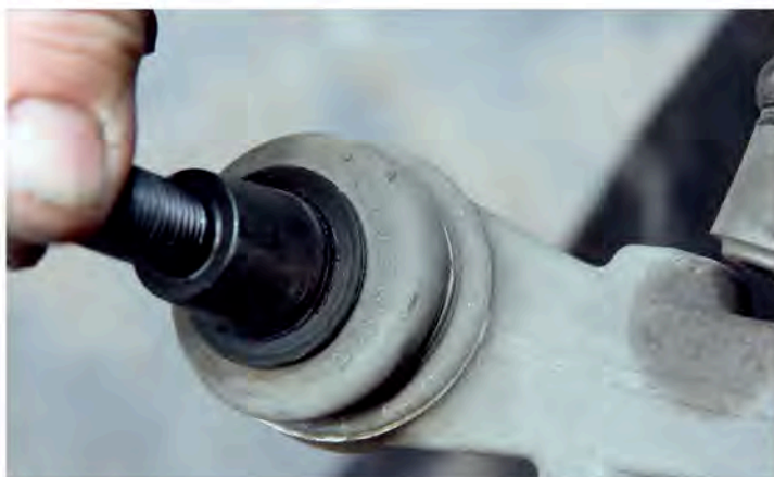
▲ Рычаги от всемирно известных производителей не имеют в своей конструкции упрощенных деталей или со сниженным уровнем качества деталей. Представленный на фото имеет пробег далеко за 100 000 км. При этом пыльник не просто цел, но и сохранил герметичность, не допуская проникновения внутрь шарнира воды и абразива
