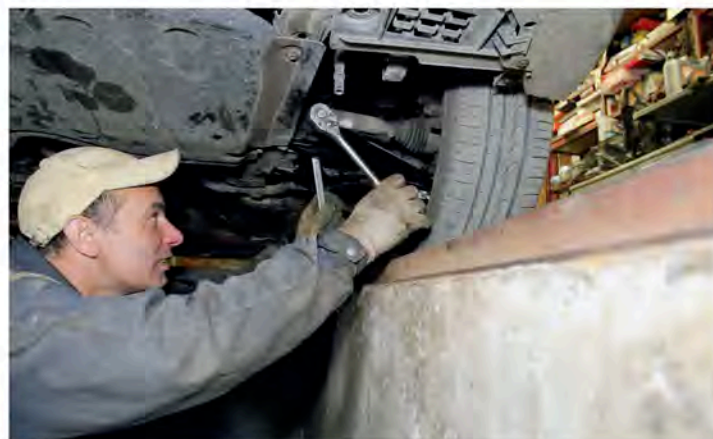
▲ Затяжка болтов крепления рычагов производится строго определенным моментом на стоящем на опорной поверхности автомобиле. Для данной операции необходим динамометрический ключ. Если пренебречь данным правилом, то работа сайлентблоков будет нарушена, а срок их службы сокращен
