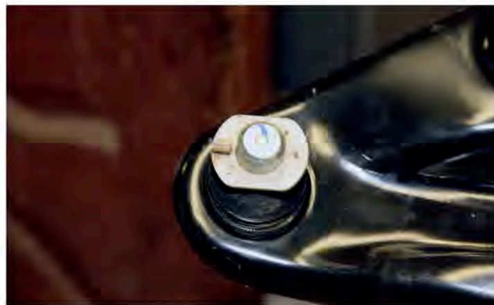
▲ На пальцы шаровых опор могут устанавливаться специальные проставки из пластика, которые имеют входящий в соответствующую прорезь выступ для фиксации их положения. К сожалению, данные элементы часто теряются и не входят в комплект новых рычагов
