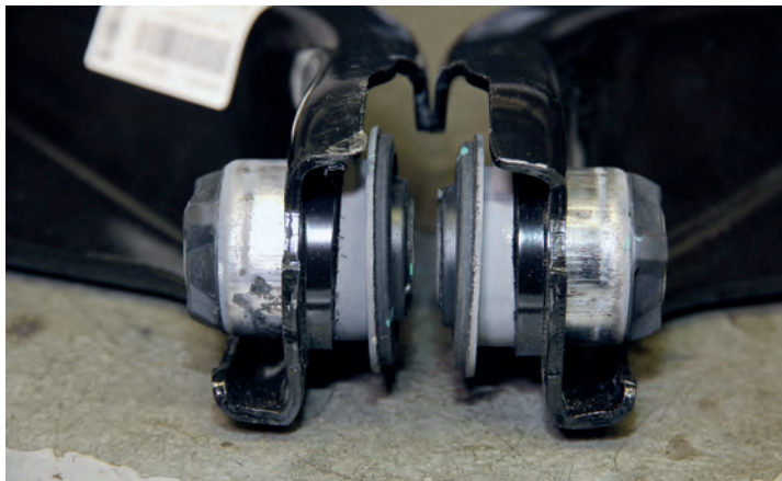
▲ При выборе рычагов от альтернативных производителей важно сравнить толщину листа, из которого они изготовлены, в сравнении с оригинальной деталью. Более тонкий лист стали может не гарантировать требуемую жесткость и прочность конструкции
