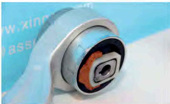
▲ Резинометаллические шарниры, впредсываемые в «уши» рычагов, могут иметь комбинированную конструкцию. Это приводит к удорожанию деталей. Кроме того, достаточно часто приобрести отдельно сложный конструктивно сайлент-блок не представляется возможным
