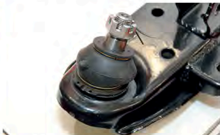
▲ В качестве дополнительной меры фиксации впредсыванной в рычаг шаровой опоры может применяться стопорное кольцо. Однако присутствие данного элемента не гарантирует, что при замене шаровой опоры новая сядет на свое место с тем же усилием (натягом). Место посадки опоры также деформируется
