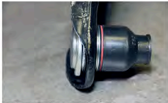
▲ Запрессовываемые в рычаг шаровые опоры – отличное решение с точки зрения упрощения технологии заводской сборки рычагов, но у ремонтников данный метод крепления шарнира восторга не вызывает
