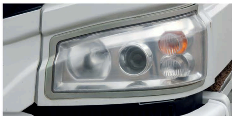
▲ Если покрывное стекло фары помутнело от «пескоструя», полировать его нет смысла. Возможно, что и с отражателем также есть проблемы – помутнение и отслоение. Проще поменять фару целиком. Благо обойдется это в 3-3,5 тысячи рублей. С «противотуманками» также проблем нет – купите тысячи за две
