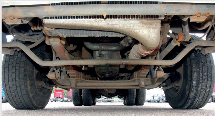
▲ Обделенные вниманием механика шкворни потребуют замены довольно быстро, особенно если машина работает с максимальной нагрузкой в пыльном карьере. Ремонтный комплект запасных частей на ось обойдется примерно в 3,8–4,0 тысячи рублей. Более дешевые варианты рассматривать не стоит. Их качество и ресурс оставляют желать лучшего
