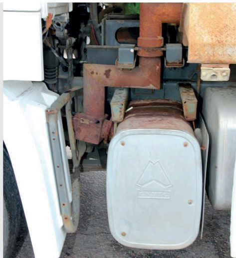
▲ Эта трехколенная, покрытая окислами труба подводит выхлопные газы от двигателя в полости самосвального кузова для его обогрева. В холодное время года подогрев предотвращает замерзание мокрого грунта к днищу и стенкам, обеспечивая полную выгрузку содержимого кузова. В теплое время года выхлопные газы поступают в глушитель. Направление движения потока газов регулируется заслонкой. Стоимость глушителя составляет более 7000 рублей. Во многих случаях проще и дешевле заварить тот, что есть
