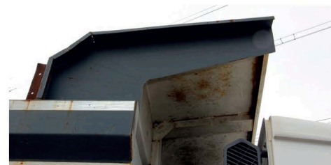
▲ Козырек самосвального кузова закрывает элементы гидравлической системы, в том числе маслобак и гидроцилиндр, расположенные за кабиной грузовика. Что стоило конструкторам совсем немного удлинить данный элемент и прикрыть хотя бы часть кабины, защитив ее от возможного просыпания грунта при его погрузке экскаватором?
