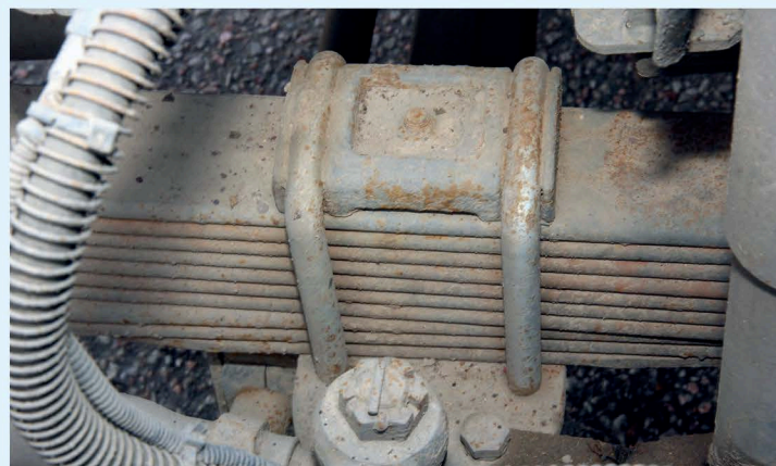
▲ Пакет передней рессоры, осмотренного нами самосвала, состоял из десяти листов. Для трехосной машины строительного сегмента, которая часто работает с перегрузом, такое решение является правильным. При этом стоит отметить, что чем больше листов в пакете, тем жестче рессора и тем сильнее трясет в кабине. Цена передней рессоры начинается от 15 000 рублей. Новые стремянки обойдутся примерно по 600 рублей штука
