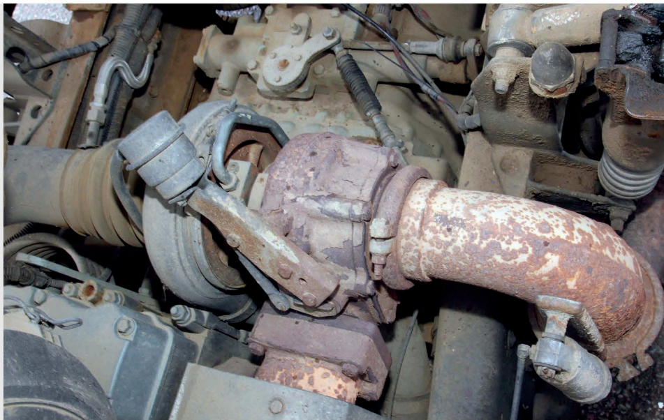
▲ На корпусе турбокомпрессора отлито имя бренда, к которому он принадлежит – Holset. Агрегаты данного производителя славятся своей надежностью в сложных условиях эксплуатации. Устанавливаемый на грузовиках ТКР изготовлен в Китае. В эксплуатации особого внимания со стороны сервисной службы требует стальная трубка подвода масла к турбокомпрессору. Бывали случаи, когда из-за нарушения герметичности ее шва наблюдалась течь масла, которое попадало на раскаленный докрасна корпус турбокомпрессора. Главное, чтобы водитель вовремя заметил данную проблему и дело не дошло до возгорания. Новый турбокомпрессор оценивается примерно в 20 000 рублей, а цена трубки составляет 550–650 рублей
