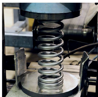
Рис. 3. Осадка включает в себя полное сжатие пружины для повышения позитивного остаточного напряжения
