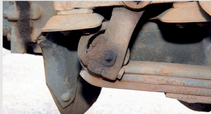
▲ Китайский грузовик требует постоянного внимания к точкам смазки. А их на «трехоснике» четыре десятка! Чтобы обойти все пресс-масленки и пополнить в них смазку нужно часа полтора. Если из-за отсутствия должного обслуживания втулки рессор потребуют замены, то отдадите примерно по 150–250 рублей за штуку в зависимости от качества. Но лучше приобретать комплекты с пальцем. Качественные запчасти обойдутся в 600–650 рублей
