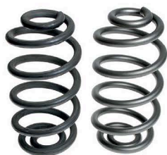
Рис. 2. Винтовая пружина до (справа) и после (слева) дробеструйной обработки. Улучшенные показатели усталости материала и оптимальная поверхность для покраски
