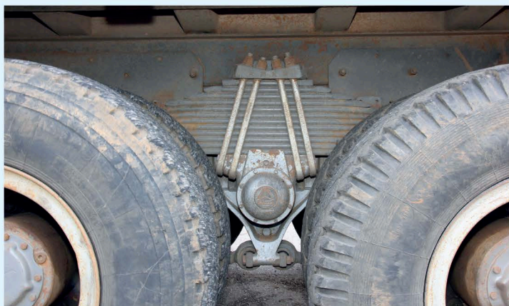
▲ Четыре крепкие стремянки гайками вверх намертво держат балансиры задней тележки. Обязательно оцените состояние элементов задней подвески. Если машина работала с перегрузом, да еще и по плохим дорогам, то дорогостоящего ремонта не избежать. Так, стоимость рессоры в сборе доходит до 25 000 рублей. Реактивные тяги можно купить по 4500–5100 рублей
