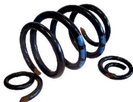
Рис. 1. Оригинальная пружина с переменным поперечным сечением с преждевременной поломкой на обеих сторонах проволоки
