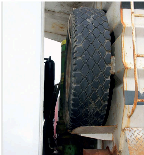
▲ Запасное колесо, традиционное для большинства самосвалов, расположено за кабиной грузовика. В нашем случае оно закреплено на специальном кронштейне на передней стенке самосвального кузова. Обязательно проверьте техническое состояние лебедки – на осмотренной нами машине она оказалась неисправной
