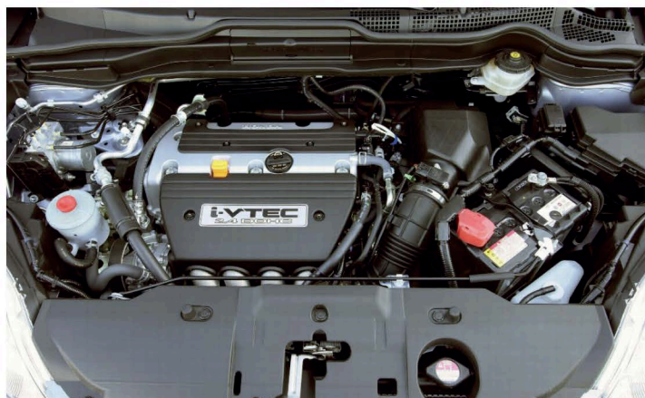
▲ Аккумулятор здесь маленький и неудобно расположен. Обычно он служит более пяти лет
