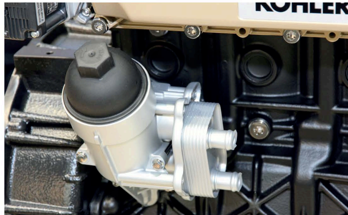
▲ Фильтроэлементы устанавливаются в специальные корпуса, монтируемые на блоке цилиндров двигателя. На теплонгруженных ДВС часто предусматривается система охлаждения масла (на фото выводы справа), которая не только поддерживает оптимальную рабочую температуру смазки, но и предотвращает ее преждевременное старение из-за интенсивного окисления
