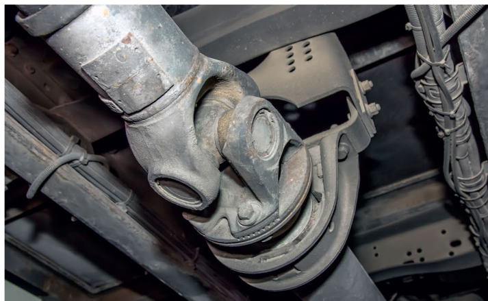
▲ При ремонте карданной передачи не ограничивайтесь лишь заменой крестовин и обязательно установите новые опоры. Если этого не сделать, то отремонтировать кардан придется опять по причине выхода из строя их подшипников
