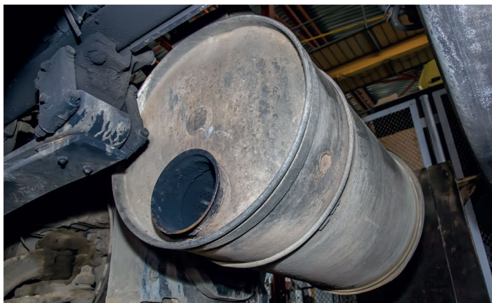
▲ На десятилетнем грузовике глушитель, скорее всего, уже будет иметь следы ремонта сваркой. Бесконечно латать его нельзя. Если ваш превратился в решето, то ищите ему замену у альтернативных производителей. Цена вопроса – от 10 000 рублей
