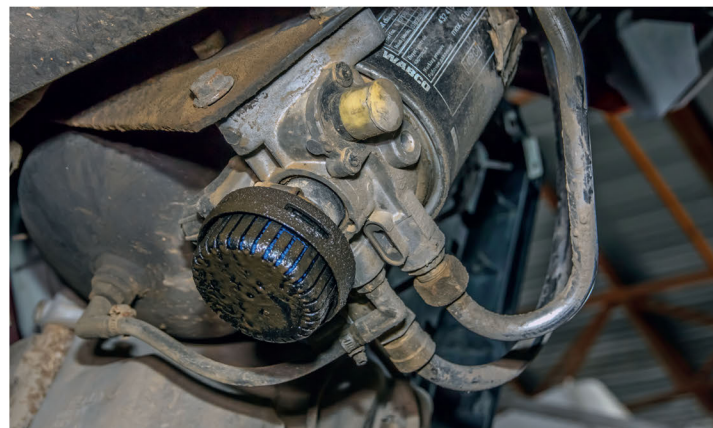
▲ При обслуживании грузовика обязательно заменяем и фильтр – осушитель воздуха пневматической системы. Если в магистрали обнаружится большое количество масла, то, скорее всего, придется ремонтировать или менять компрессор
