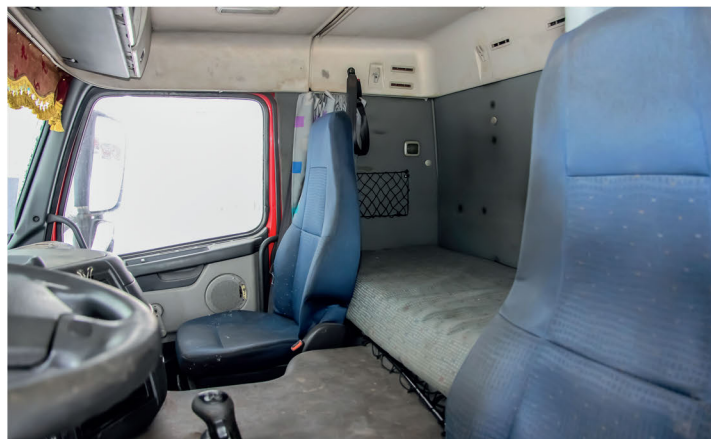
▲ Обивка кабины десятилетнего грузовика, скорее всего, потребует чистки с применением высокоэффективной химии. При этом вы не обнаружите дыр в материале, даже если речь идет о водительском кресле
