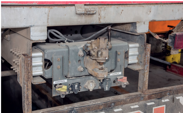
▲ Грузовик-одиночка может использоваться в качестве тягача, что существенно повышает рентабельность перевозок. При покупке грузовика обратите внимание на наличие сцепного устройства и его техническое состояние
