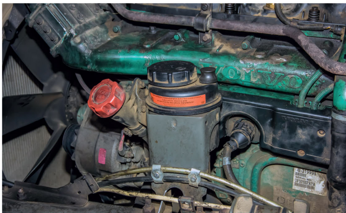
▲ Перед началом эксплуатации грузовика необходимо заменить все технические жидкости. При сливе масел важно убедиться в отсутствии металлической стружки и иных включений, которые говорят об износе агрегатов
