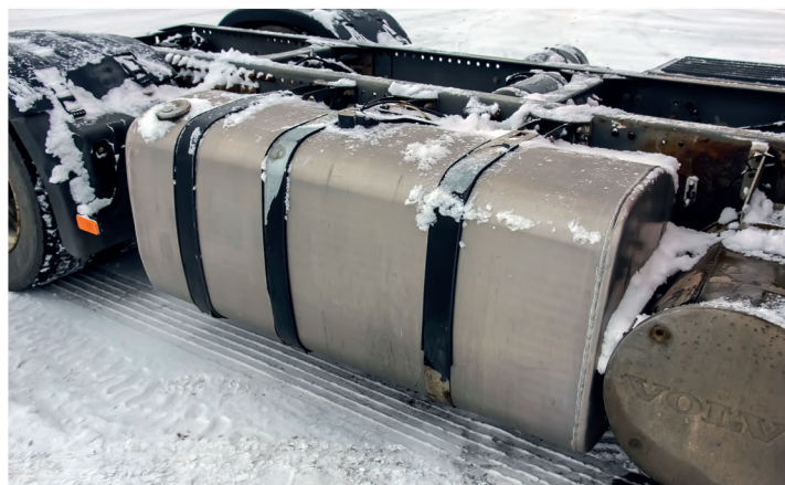
▲ Перед началом эксплуатации грузовика обязательно промываем и пропариваем топливные баки. Это позволит удалить накопившуюся на их дне грязь и значительно снизить нагрузку на фильтры
