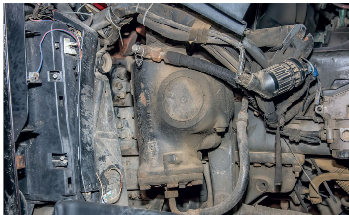
▲ Рулевая машинка достаточно надежна. При осмотре грузовика обратите внимание, нет ли на корпусе редуктора потеков масла. За ремонт агрегатов сервисмены берутся очень редко, в основном их меняют на исправные
