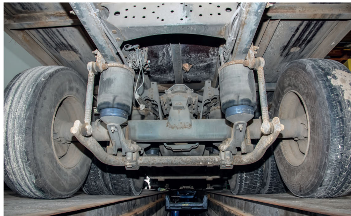
▲ «Ленивец» с односкатной ошиновкой позволяет вписаться по нормативу максимальной нагрузки на ось. Данная опция особенно полезна грузовику-одиночке, на раме которого стоит кузов большого объема
