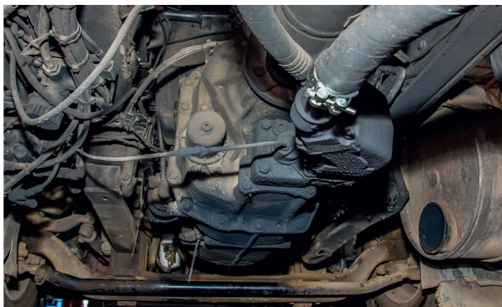
▲ К коробкам перемены передач претензий в эксплуатации очень мало. Всё, что нужно, это следить за уровнем масла в картере и своевременно устранять утечки масла через изношенные манжеты
