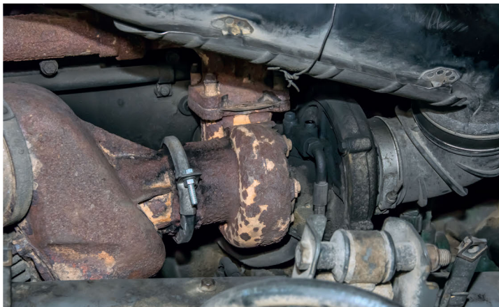
▲ Потуший маслом турбокомпрессор – повод для торга. В большинстве случаев «мокрая» турбина потребует замены. Если интеркулер или впускной тракт были негерметичны, то попадающий на насосное колесо абразив мог повредить его лопатки
