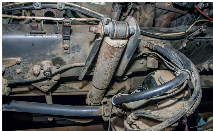
▲ При эксплуатации грузовика по дорогам плохого качества амортизаторы не выдерживают и 50 000 километров. Надежные и выносливые агрегаты от лидеров сегмента стоят не более 7000 рублей
